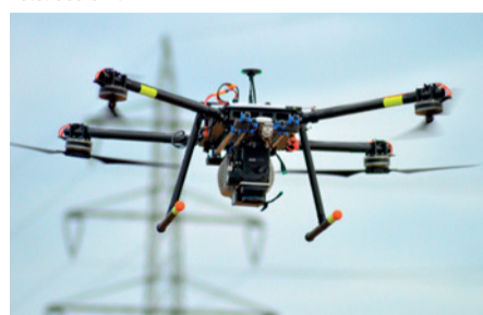
Der AeroCopter, entwickelt unter der Leitung von GGS-Mitarbeiter Thorsten Kanand, bewältigt bis zu 6 kg Traglast.
